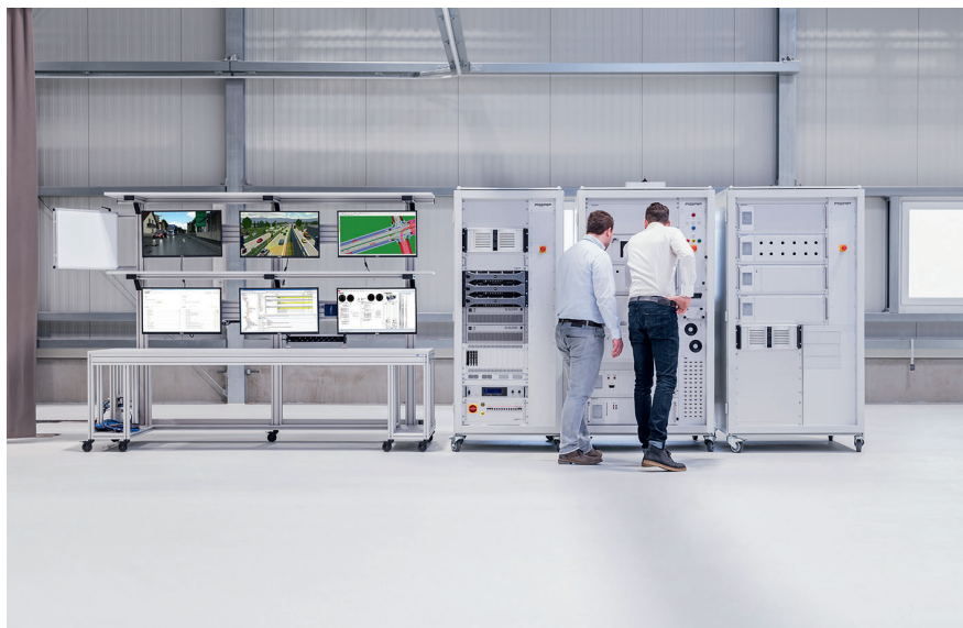
Bild 2: Closed-Loop-Prüfstand für den Einsatz der Modelle. © ASAP/Klaus Mellenthin
